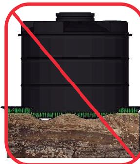
No coloque el tanque sobre terrenos irregulares, ya que no podrá mantener la estabilidad, y se dañaría el fondo de la base del mismo.
