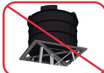
No coloque el tanque en superficies con bases en cruz, ya que partes del tanque no permanecerían estables.
