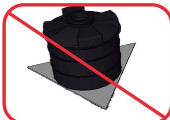
No coloque el tanque en superficies triangulares, ya que puede resultar inestable.
