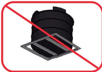
No coloque el tanque sobre perlines con separaciones muy grandes, el espacio mínimo no puede superar los 4 cm.
