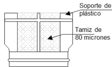
Colocar el tamiz dentro de la carcasa con la parte angulada hacia abajo.
